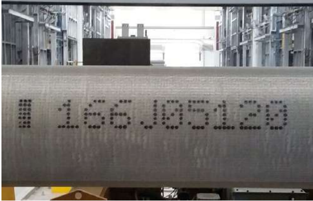
Aplicación de colores resistentes al calor en barras de aluminio
