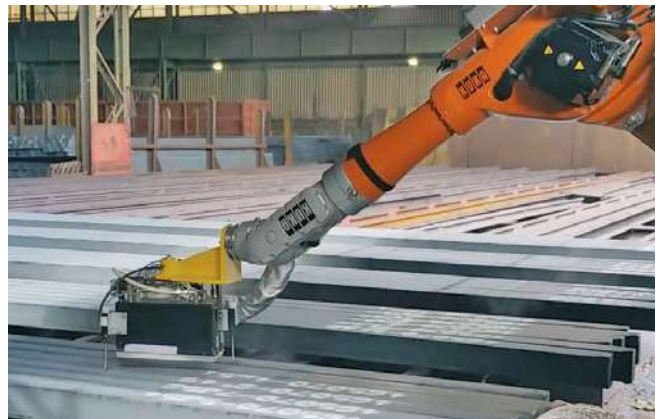
Marcado de palanquillas controlado por robot con pintura de alta temperatura
