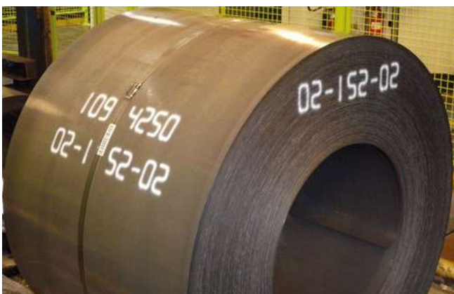
Marcado de bobinas de acero
