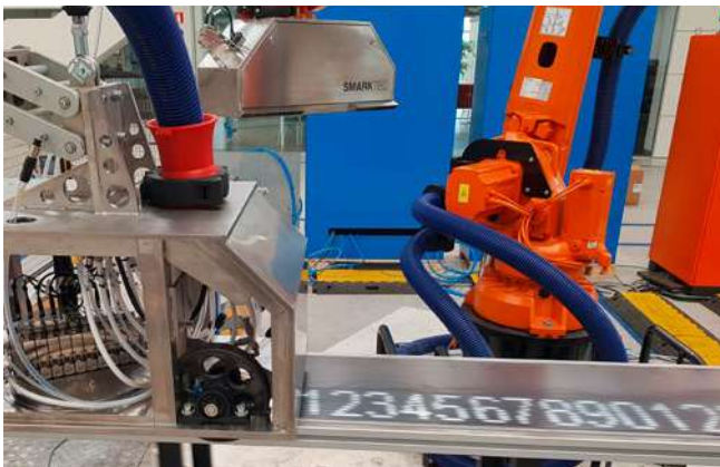
Bloque de marcado por pulverización SRP-10 para el marcado de chapa
