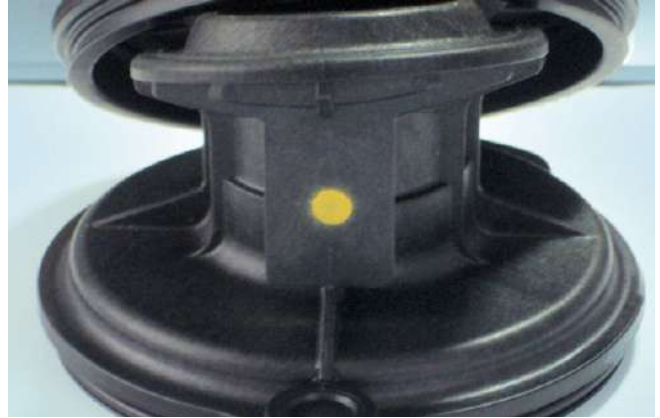
Marcado de las piezas buenas tras la inspección de calidad
