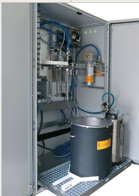
Suministro de material con elevador de tapa, calentador de flujo y tanque aislado calentable
