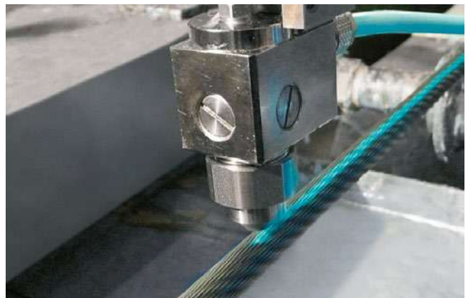
Marcado del color de los cables
