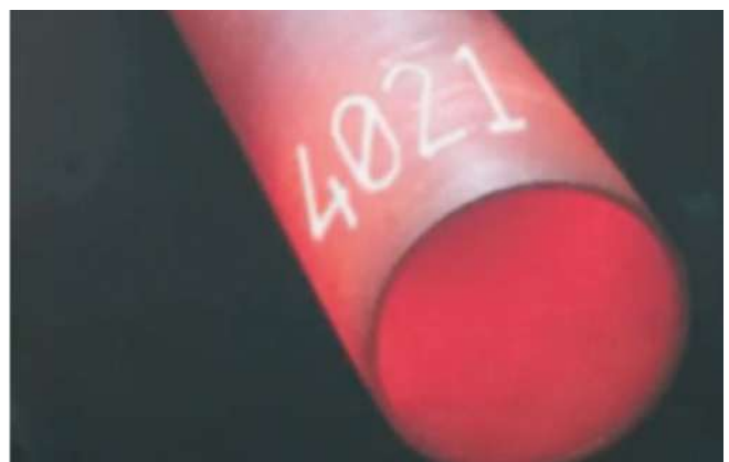
Marcado del acero al rojo vivo con pintura de alta temperatura
