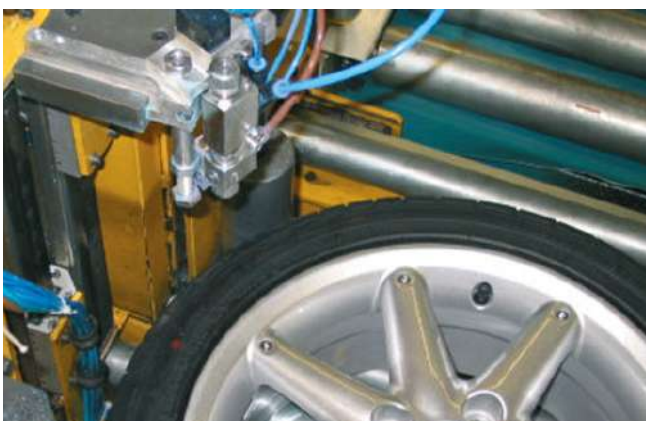
Marcado de puntos altos en los neumáticos
